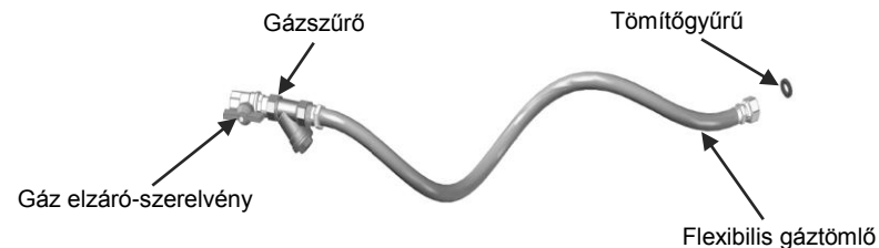
12. ábra: Csatlakoztatás flexibilis tömlővel (opció, a készülék gyártónál megvásárolható)
