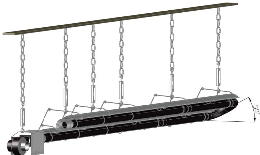
21. ábra: A beépítés maximális dőlésszege
