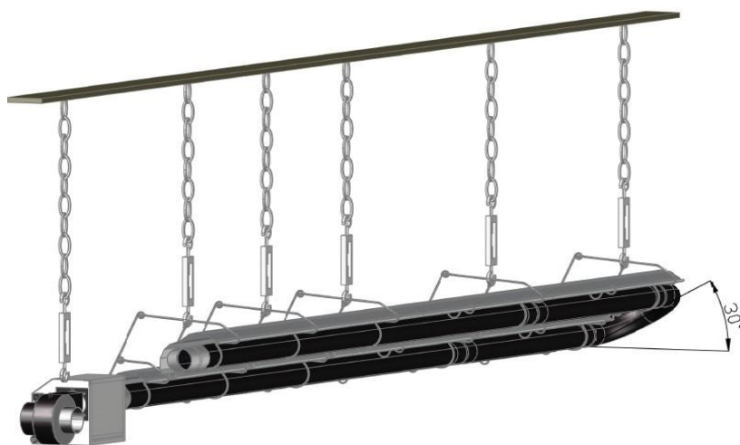
26. obrázok: Maximálny uhol sklonu pri inštalácii
